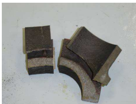
ΣΧΗΜΑ 4. Μέρος της επιφάνειας αστοχίας του οχετού
